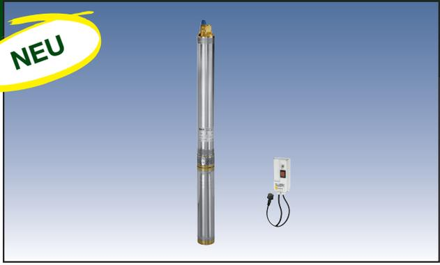
3" Brunnenpumpe aus rostfreiem Stahl AISI 304. Einsetzbar in jedem Brunnen mit einem Durchmesser ab 75 mm. Diese Pumpen sind geeignet zu Anwendungen für die Druckerhöhung in häuslichen und industriellen Wassersystemen, zum Füllen von Druckbehältern und Tanks, Druckerhöhungsanlagen und Bewässerungssysteme.
