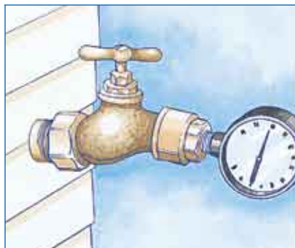
Um den Wasserdruck zu prüfen, befestigen Sie einen Druckmesser an dem Außenwasserhahn, der sich am dichtesten an der Wasseruhr bzw. Wasserquelle befindet. Druckmesser sind bei Ihrem örtlichen Hunter-Lieferanten erhältlich.
